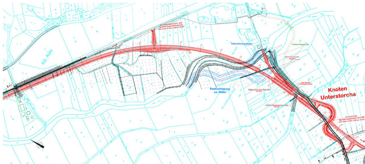
Abbildung 2-6: Variante D mit Raabverlegung
